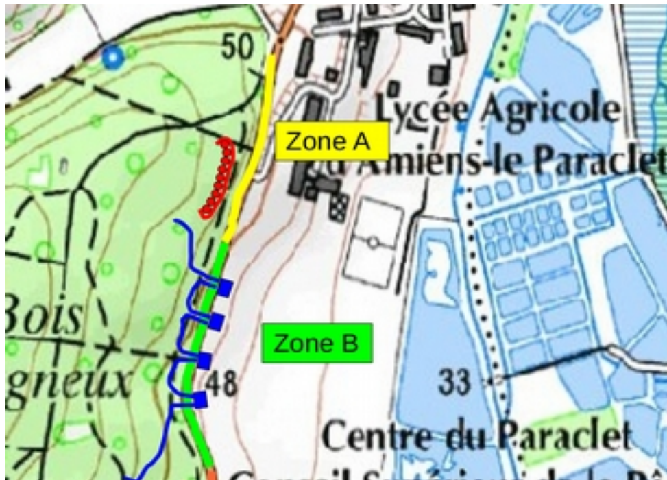
Localisation des tunnels sous la RD116 et du dispositif temporaire installé en 2014
